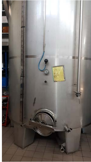
32 A-B-C: Vasche in acciaio inox refrigerate. Sistema cooling a biscotto con glycole. Capacità 250 hl ciascuna. La 32C ha tasche di raffreddamento (non coibentate), fondo conico con estrazione a pale automatica e irroratore per i rimontaggi, per vinificazione
