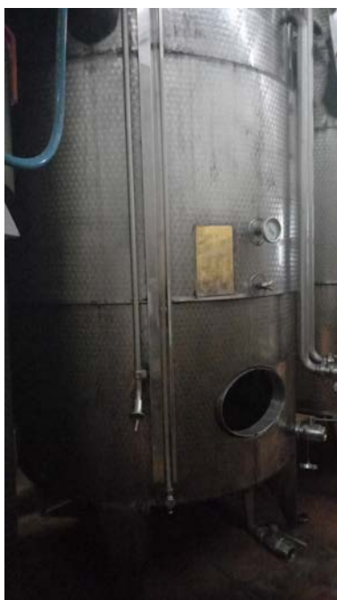
57 A-B-C-D n. 4 vasche inox refrigerate a glicole con doppia parete per cooling, capacità 50 hl
