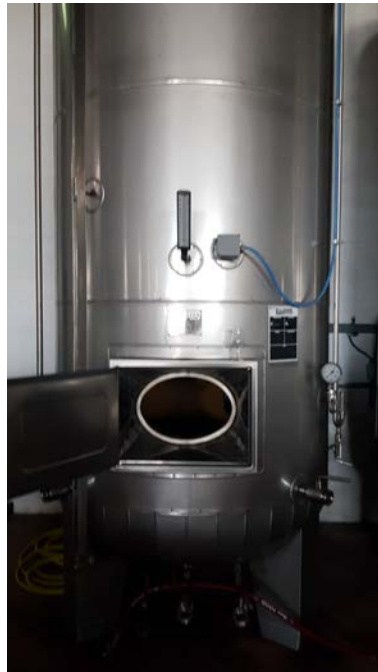
65 C-D autoclavi per spumantizzazione capacità 50 hl
