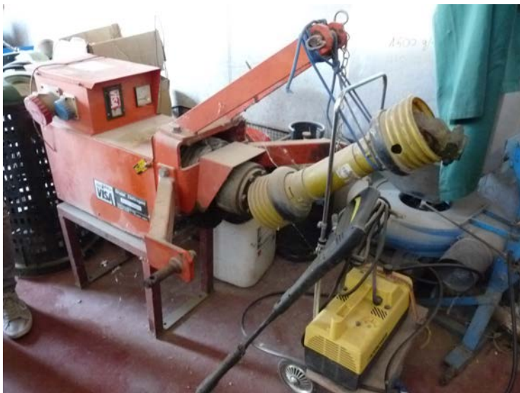
51 Gruppo elettrogeno VISA da 30 kW da attaccare alla pdp del trattore
