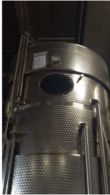
58 A-B-C-D n.4 vasche inox refrigerate a glicole con doppia parete per cooling, capacità 25 hl
