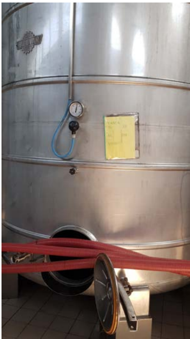
33 A-B-C: Vasche in acciaio inox AISI 316 (con Molibdeno) refrigerate Ditta Padovan modificate per uso enologico
