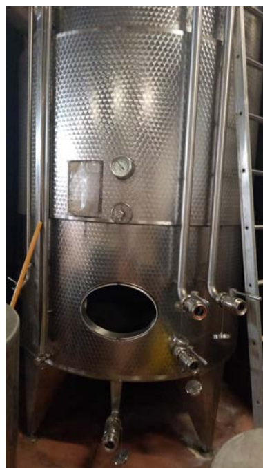
57 A-B-C-D n. 4 vasche inox refrigerate a glicole con doppia parete per cooling, capacità 50 hl
