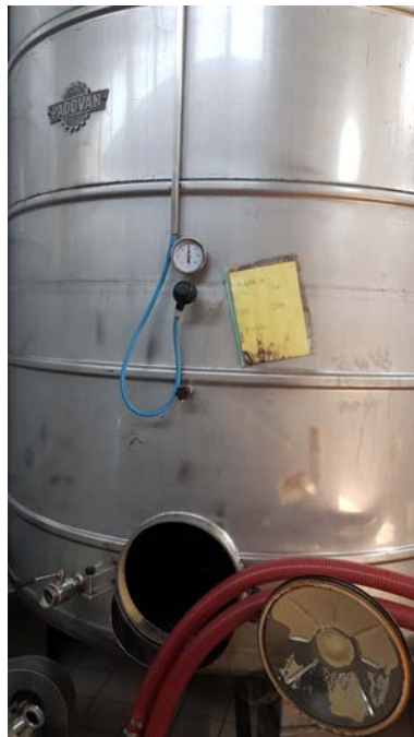
33 A-B-C: Vasche in acciaio inox AISI 316 (con Molibdeno) refrigerate Ditta Padovan modificate per uso enologico
